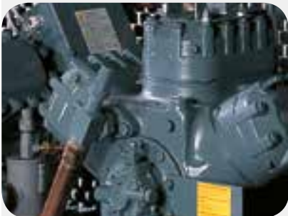
Rubinetti per poter isolare ogni singolo elemento del circuito. Taps for isolating every single element in the circuit. Robinets pour isoler chaque élément simple du circuit. Hähne zum Isolieren jeder Elemente des Kreislaufes. Grifos para poder aislar cada elemento del elemento del circuito. Отсекающие вентили для изоляции каждого отдельного элемента контура.
