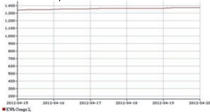
Figura 9 – Cumulata energia elettrica assorbita dai ventilatori di condensazione del roof-top al giorno 15/04/2012.
