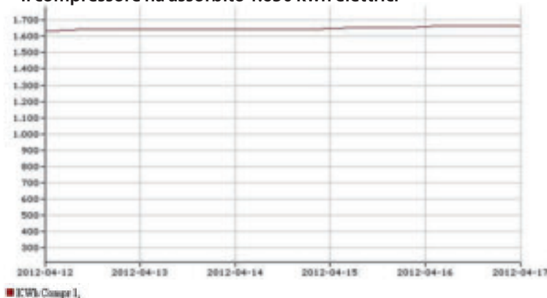
Figura 8 – Cumulata energia elettrica assorbita dal compressore 2 del roof-top al giorno 15/04/2012.
