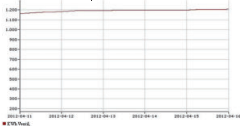
Figura 10 – Cumulata energia elettrica assorbita dalla resistenza elettrica per acqua calda sanitaria al giorno 15/04/2012.
